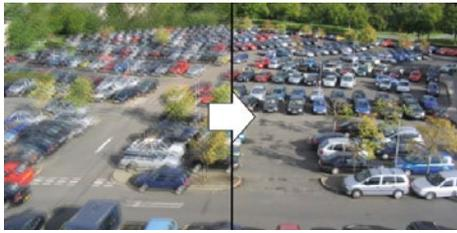
Ein digitaler Bildstabilisator gleicht kleine Verwacklungen aus, die zum Beispiel durch Wind bei einer Mastmontage auftreten können.
